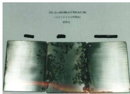
写真 2 塩水噴霧試験後脱脂後
